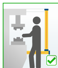
Bild 7: Montering med litet säkerhetsavstånd
