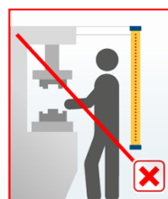
Bild 8: Vid mycket högt säkerhetsavstånd måste en säkerhetsljusridå monteras horisontellt.
