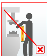
Bild 7: Montering med litet säkerhetsavstånd
