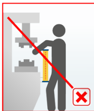
Abb. 7: Installation bei geringem Sicherheitsabstand.
