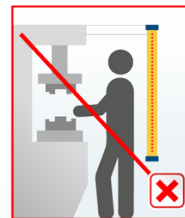
Abb. 8: Bei einem sehr hohen Sicherheitsabstand, ist die horizontale Anbringung eines Sicherheitslichtvorhangs erforderlich.
