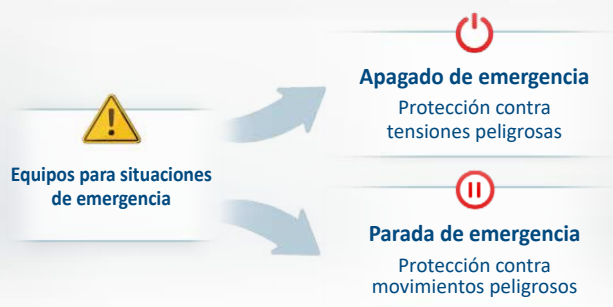
Fig. 1: Diferencia entre interruptores de parada de emergencia y de apagado de emergencia
