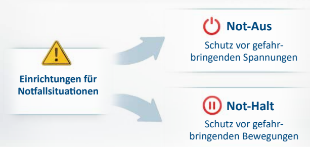
Abb. 1: Unterschied zwischen Not-Halt- und Not-Aus-Schaltern
