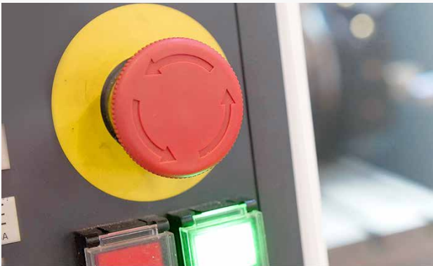
Abb. 2: Not-Halt-Schalter müssen gut sichtbar sein
